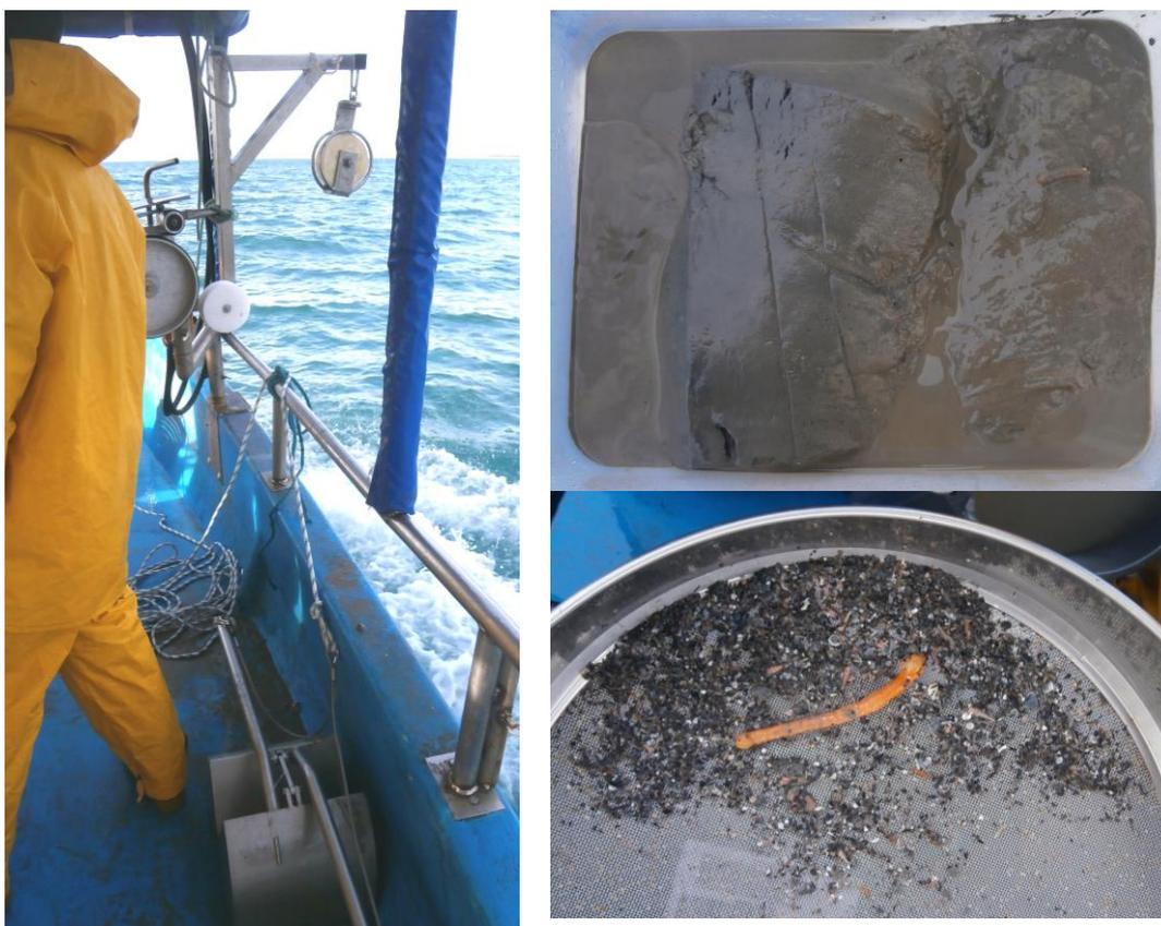
Figure 11 : benne Van Veen en action et prélèvement de sédiments marins.
