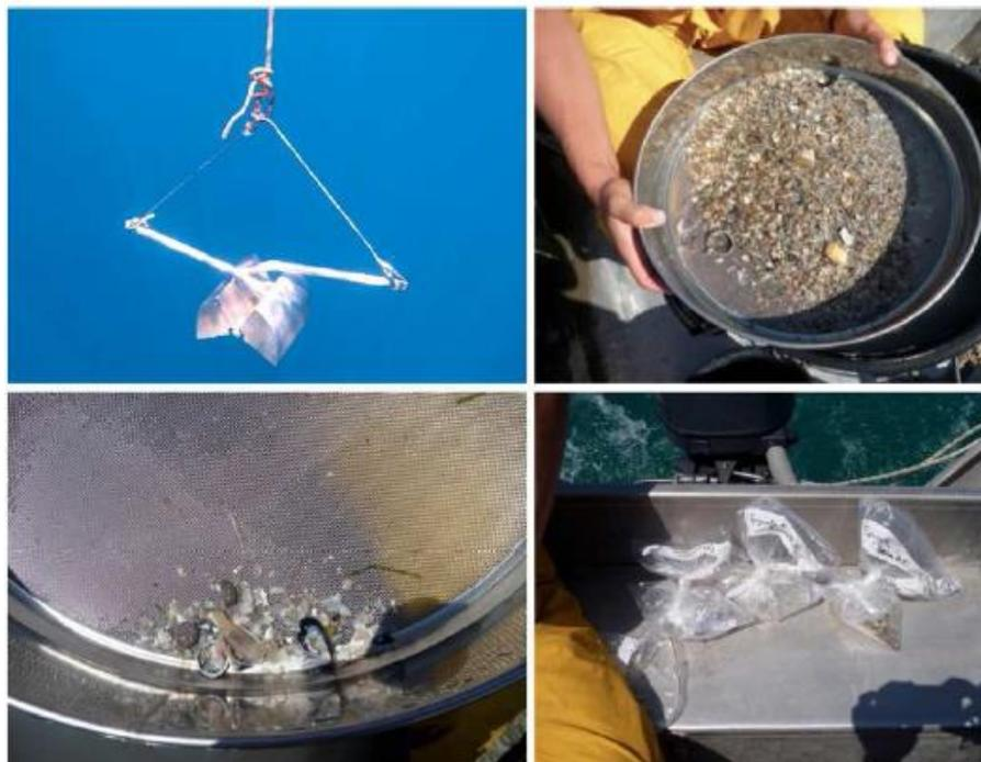
Figure 10 : Prélèvement à la benne, tamisage et conditionnement des échantillons.
