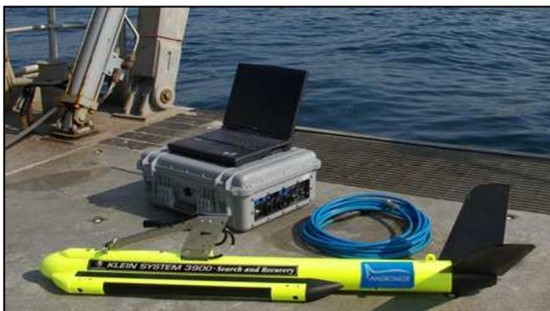
Photo 10 : Sonar Klein 3900 [1] ; Mise à l'eau du sonar [2]
