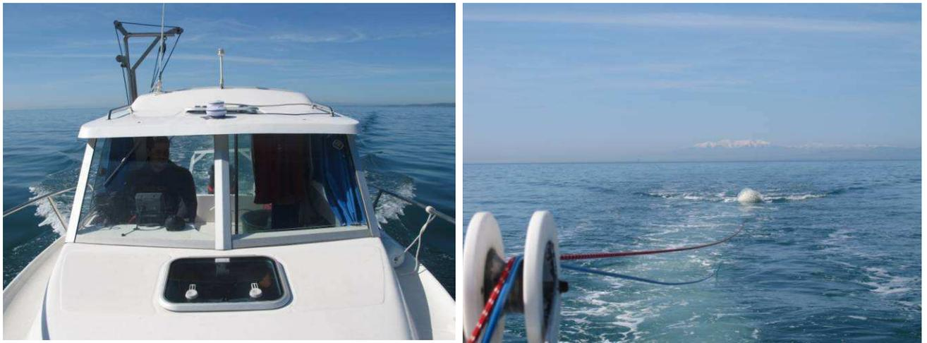
**Photo 8 : Merry Fisher avec barre de relevage en inox [1] Sonar latéral et poulie [2]**
